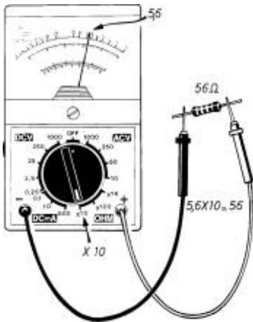
L'unità di misura delle resistenze prende il nome di « ohm » (abbrev.  $\Omega$ ). Molto spesso in elettronica si fa uso di resistenze con valori relativamente elevati, ossia si fa uso dei
