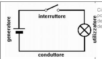
Circuito aperto: si definisce tale in quanto la posizione (aperta) della levetta dell'interruttore non consente il passaggio della corrente elettrica
