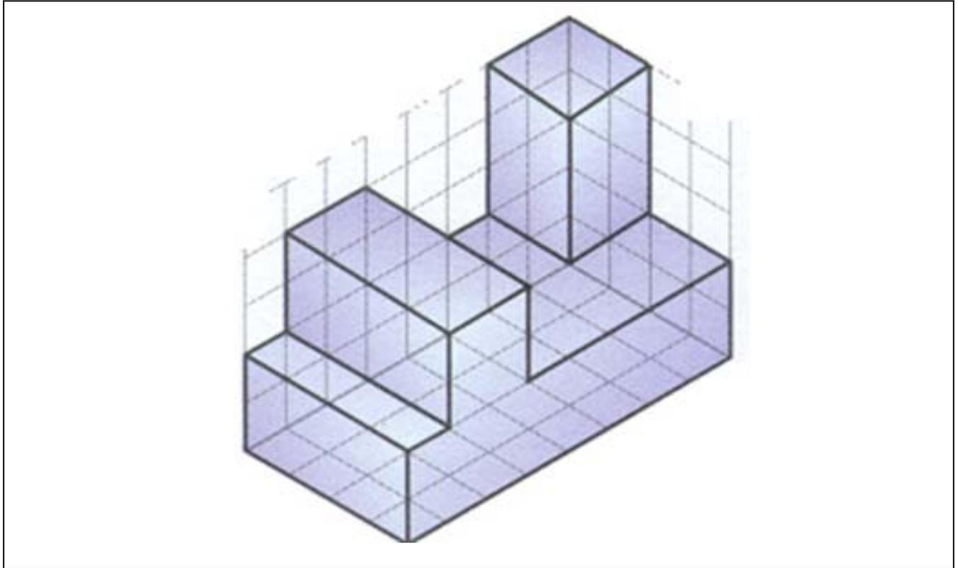
*Eeguire l'assonometria isometrica della figura sopra riportata , in scala 1:1*
