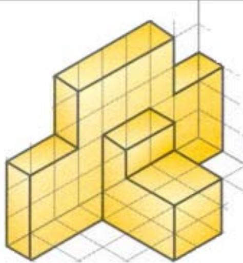
*Eeguire l'assonometria isometrica della figura sopra riportata , in scala 2:1*
