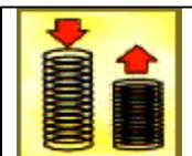
**Resistenza a fatica:** è la resistenza dei materiali a sforzi variabili e ripetuti (ad esempio, l'accorciamento e l'allungamento di una molla ripetuto per migliaia di volte)
