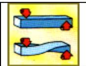
**Resistenza alla torsione:** un corpo è sollecitato a torsione quando le forze applicate tendono a torcere le sue fibre.
